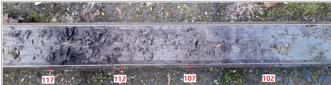
Figuur 12: Groningen, Verzetssrijderslaan 2-4: monster boring 14 van circa 100 tot 120 centimeter diepte. In de klei zijn twee vegetatieniveaus zichtbaar: van 102 tot 107 en van 112 tot 117 centimeter beneden maaiveld.
