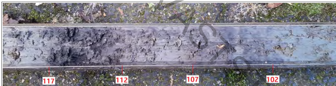
Figuur 12: Groningen, Verzetsstrijderslaan 2-4: monster boring 14 van circa 100 tot 120 centimeter diepte. In de klei zijn twee vegetatieniveaus zichtbaar: van 102 tot 107 en van 112 tot 117 centimeter beneden maaiveld.
